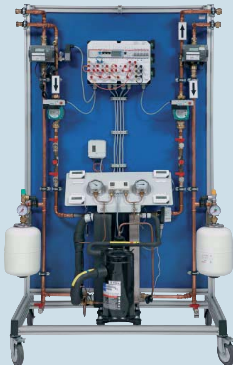
S5 Bomba de calor
