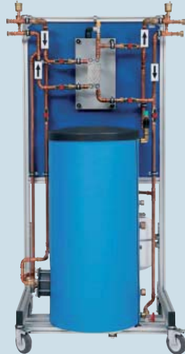
S4 Cambio hidráulico, intercambiador de calor por placas y acumulador intermedio
