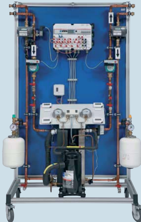
S5 Bomba de calor
