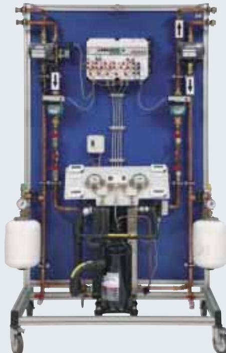
P5 Bomba de calor
