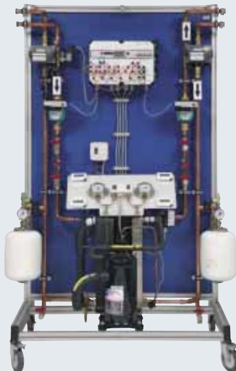
P5 Bomba de calor
