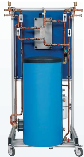
S4 Cambio hidráulico, intercambiador de calor por placas y acumulador intermedio
