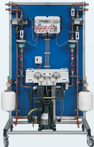
S5 Bomba de calor
