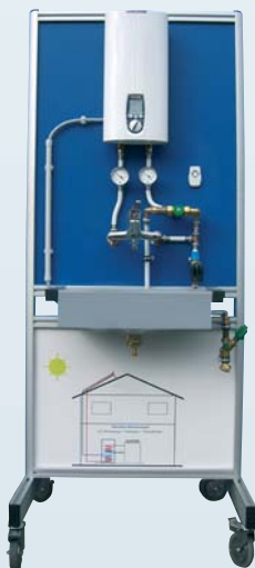
sobre DIN 1717 agua potable: preparación de agua caliente mediante calentador continuo electrónico
